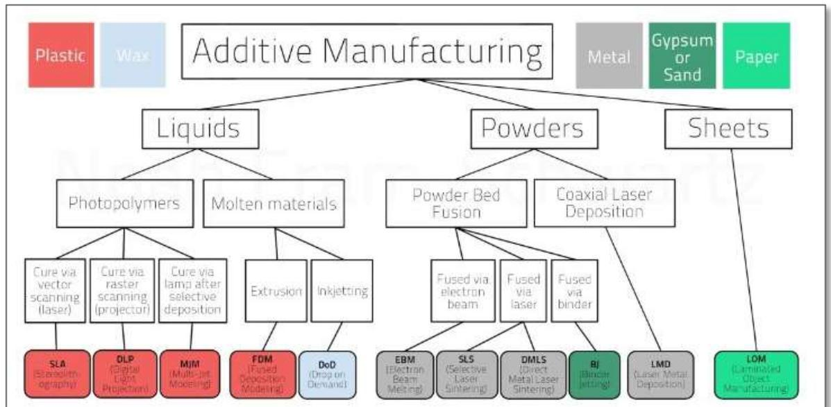
Figure 1 : Panorama des technologies de fabrication additives
